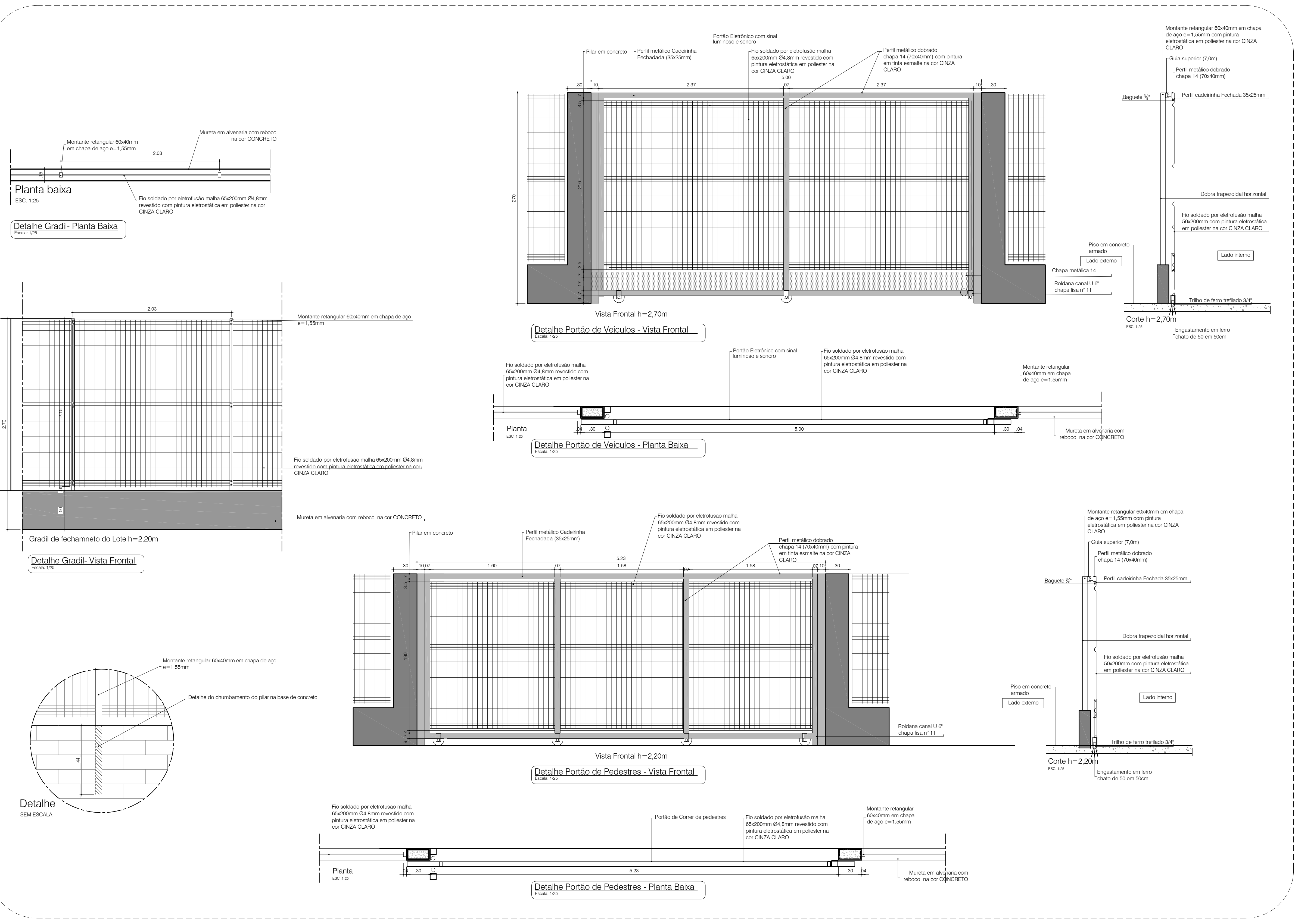
05 Detalhe Gradi e Portões ESC. 1:25
